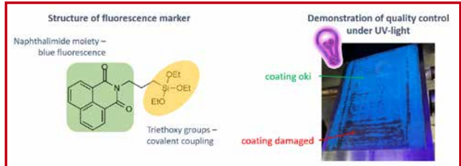
Chemische Struktur des Fluoreszenzmarkers NIPTES (links) und Demonstration der fluo-reszenz-basierten Qualitätskontrolle anhand einer beschichteten Platte nach Gebrauch im Spritz-gusswerkzeug Chemical structure of the fluorescent marker NIPTES (left), and demonstration of the fluorescence based quality control at the example of a coated steel plate after use for injection molding (right).
