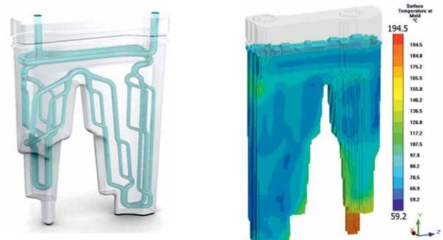
Abb. 1: Oberflächentemperatur des bionisch gekühlten Formeinsatzes 1.5 s nach erstem Schmelzkontakt.
