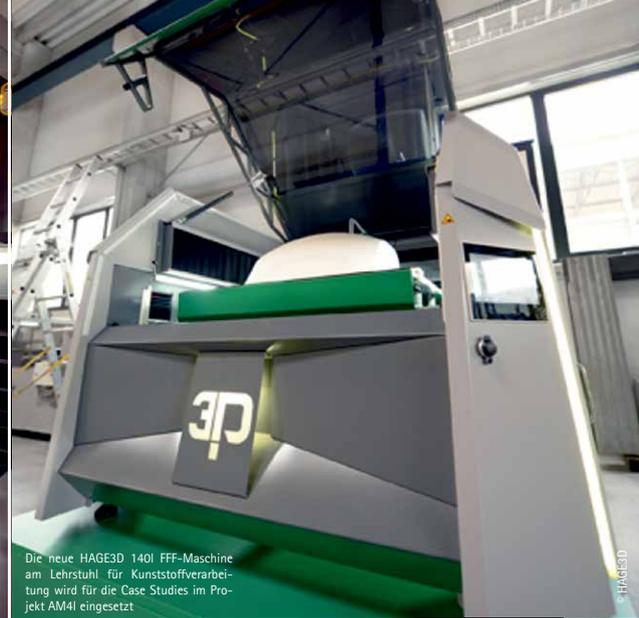
Die neue HAGE3D 140I FFF-Maschine am Lehrstuhl für Kunststoffverarbeitung wird für die Case Studies im Projekt AM4I eingesetzt
