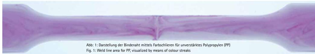
Abb. 1: Darstellung der Bindenaht mittels Farbschlieren für unverstärktes Polypropylen (PP)
