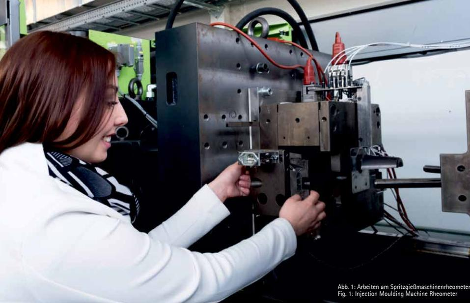
Abb. 1: Arbeiten am Spritzgießmaschinenrheometer
