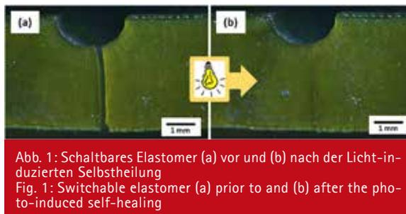
Abb. 1: Schaltbares Elastomer (a) vor und (b) nach der Licht-induzierten Selbstheilung
