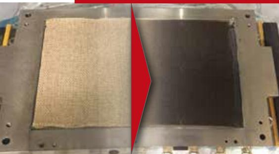
schwerpunkt auf Seiten der MUL ist die systematische Analyse geeigneter Harz-Härter-Mischungen zur Herstellung leistungsfähiger, biobasierter Duromere. Im Flüssigimprägnierprozess werden die Naturfaserverstärkung und der polymere Matrixwerkstoff im Anschluss zum Verbundbauteil verarbeitet. Die Analyse der Materialeigenschaften während der Verarbeitung durch Einsatz unterschiedlicher Sensortechnologien und die Entwicklung einer
