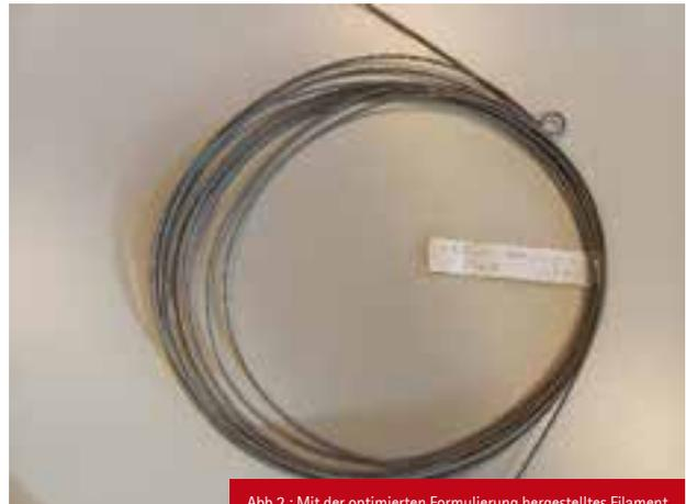
Abb 2.: Mit der optimierten Formulierung hergestelltes Filament
