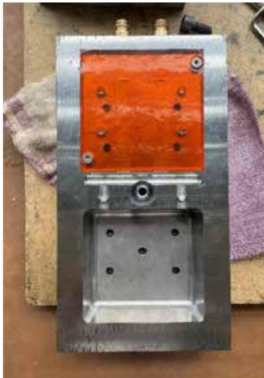
Abbildung 1: Additiv gefertigte Einsätze für Spritzgußwerkzeuge
