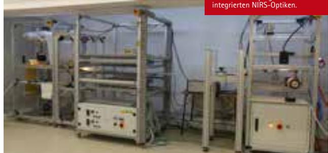
Modularer Prepreg-Prüfstand mit integrierten NIRS-Optiken.
