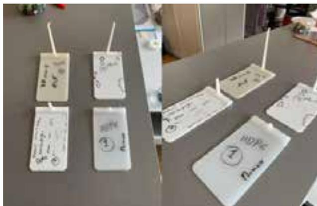
Abb. 1: Spritzgegossene HDPE und POK-Proben
