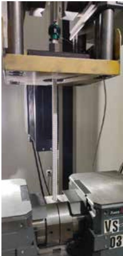
Abb. 1: Mit Dehnungssensoren instrumentierte Gebirgsanker
