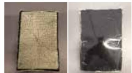
Abb. 3: Aramidfaserverstärkte Testplatten nach Impactprüfung
