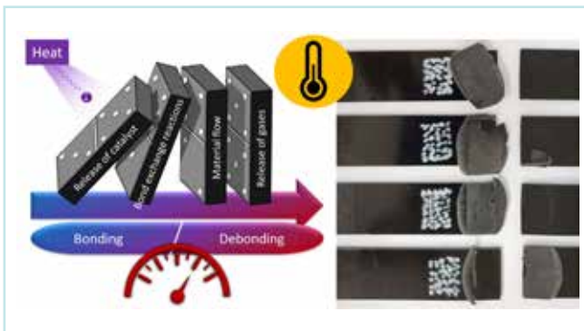
Abb. 1: Thermisch gesteuertes Trennen von Klebeverbindungen / Fig. 1: Thermally triggered debonding of adhesives
