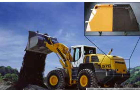
Oben: Projektdemonstrator Liebherr L576 Radlader-Heckklappe, hergestellt aus nachwachsenden Rohstoffen. Rechts: Rasterelektronenmikroskopie zur Bruchfläche eines ELSO-CA-Composites. Top: Project demonstrator Liebherr L576 wheel loader tailgate, made from renewable raw materials. Right: Scanning electron microscopy of the fracture surface of an ELSO-CA composite.
