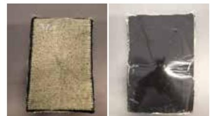
Abb. 3: Aramidfaserverstärkte Testplatten nach Impactprüfung
