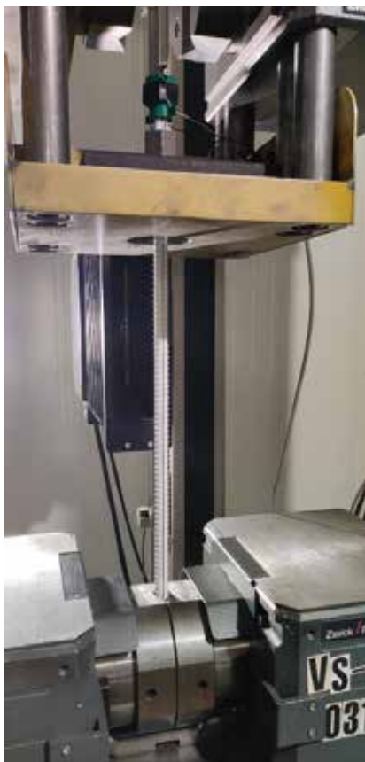
Abb. 1: Mit Dehnungssensoren instrumentierte Gebirgsanker Fig. 1: Rock bolts instrumented with strain sensors
