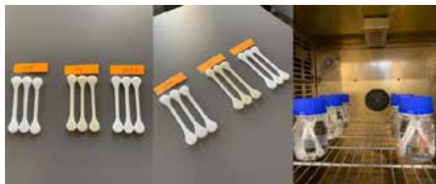
Abb. 2: Spritzgegossene Hantelstäbe im Alterungsprozess Fig. 2: Injection molded Dumbbell specimens under aging
