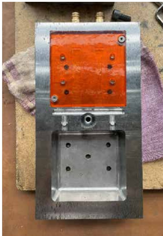
Abbildung 1: Additiv gefertigte Einsätze für Spritzgußwerkzeuge Figure 1: Additively manufactured inserts for injection molds
