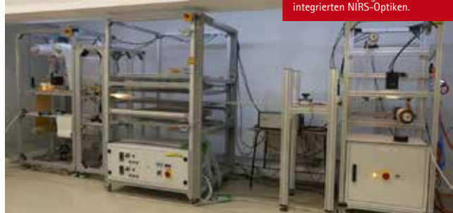
Modularer Prepreg-Prüfstand mit integrierten NIRS-Optiken.
