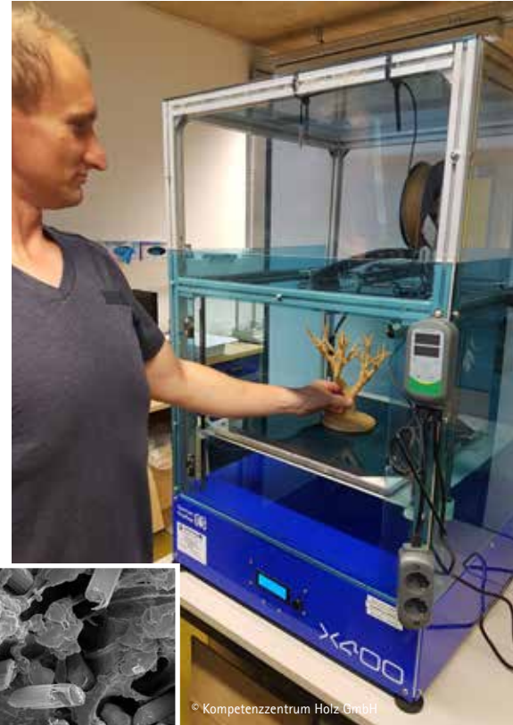
Links: Bruchfläche eines faser-verstärkten FFF-Materials Left: Fracture surface of a fiber-reinforced FFF material
