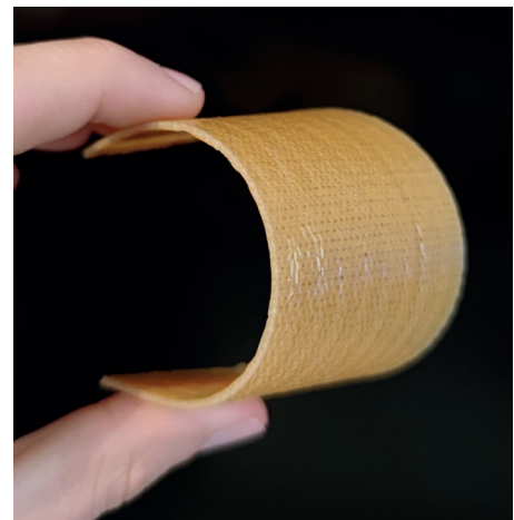
Mechanisch flexibles Composites/Halbzeug und Demonstratorbauteil Handgelenklagerungsorthese Mechanically flexible composites/semi-finished product and demonstrator component wrist bearing orthosis
